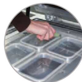
Fustellatura manuale delle vaschette Manual trays cutting
