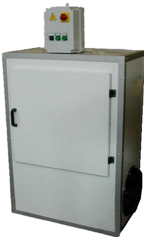
L'essiccatoio statico EC 8 è un essiccatoio per la pasta fresca in grado di essiccare fino a 24 Kg di pasta. L'essiccatoio è formato da un armadio al cui interno vi è una rastrelliera che può contenere fino ad 8 telai per essiccare la pasta fresca.
