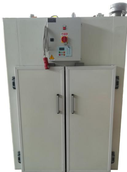
L'essiccatore EC 50 consente di essicare perfettamente qualsiasi tipo di pasta e, impostando opportunamente i parametri di temperatura, umidità e tempi di pausa e rinvenimento, è possibile utilizzare la macchina anche per essicare altri tipi di prodotti.
