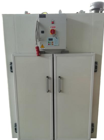
L'essiccatore per la pasta EC 25 consente di essicare perfettamente qualsiasi tipo di pasta e, impostando opportunamente i parametri di temperatura, umidità e tempi di pausa e rinvenimento, è possibile utilizzare la macchina anche per essicare altri tipi di prodotti.
