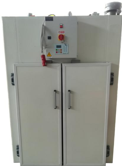
L'essiccatore EC 150 consente di essicare perfettamente qualsiasi tipo di pasta e, impostando opportunamente i parametri di temperatura, umidità e tempi di pausa e rinvenimento, è possibile utilizzare la macchina anche per essicare altri tipi di prodotti.
