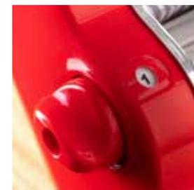
Inserire il selettore dello spessore e ruotarlo nella posizione n.1.
