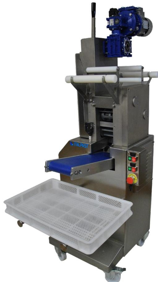
La raviolatrice RA 120 è una macchina automatica a stampi intercambiabili che utilizza due sfoglie da 120mm di larghezza per una produzione di ravioli che va dai 40 agli 80 kg/h.
